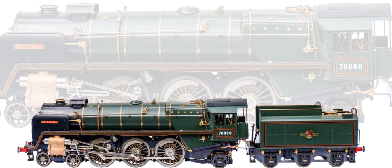
593 Timken große 2-C-1 englische DampfloK „Britannia“, Nr. 70000, mit 3A Versorgungstender, Dampfbetrieben, HL, schwere detailgetreue Ausführung, Spurweite 9,5, Gesamtlänge 140, Z 1-2
