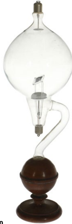
8720 Crooksche Röhre zum Nachweis der thermischen Wirkung von Kathoden- strahlen, L 40 Crook tubes to proof the thermal effect of cathode radiation, L 40 40,- €
