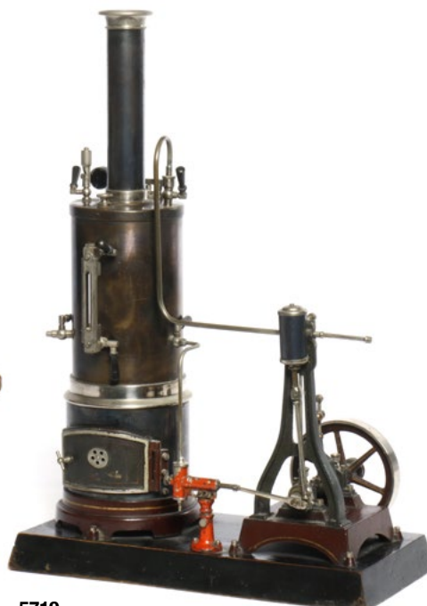
5719 Schiffsdampfmaschine, stehender patinierter Kessel, KD 9, mit Armaturen und Brenner, auf rundem Guss-Sockel, HL, feststehender Zylinder mit Schiebersteuerung und Speisepumpe, auf gemeinsamen Holz-Sockel, Alterungs- und Gebrauchsspuren, L 30, noch Z 2 400,- €
