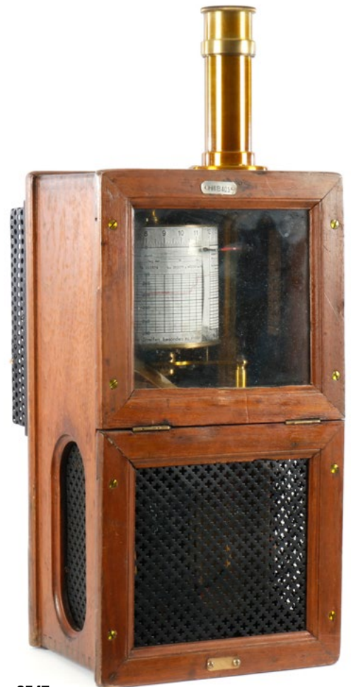
8547 Automatisches Aufzeichnungsgerät mit Papierrolle im Holzgehäuse, mit Federwerk, um 1900 Automatic antique recorder with paper roll in wooden case, with clockwork, around 1900 100,- €
