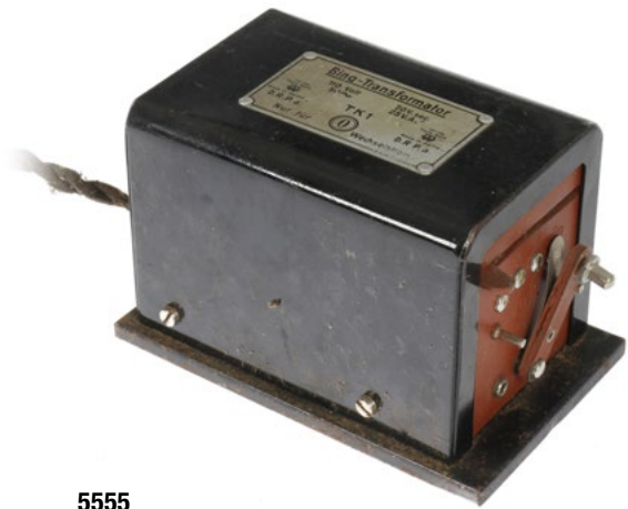
5555 Transformator 110 V AC – 20 V DC, von Gebrüder Bing Nürnberg 10,- €
