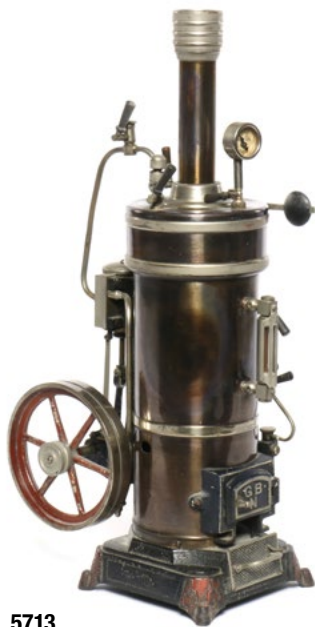
5713 Bing stehende Dampfmaschine, patinierter Kessel, KD 10, mit Armaturen und Brenner, feststehender doppelwirkender Zylinder, Guss-Sockel, HL, mit Regler und Speisepumpe, leichte Gebrauchsspuren, H 42, Z 2 500,- €
