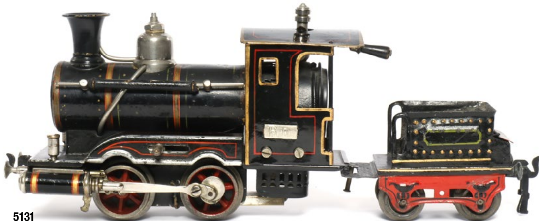
5131 Märklin B-Dampflok R 4020, S 0, uralt, spiritusbetrieben, schwarz, mit Tender, Brenner, Pfeife und 2 feststehenden Zylindern, Führerhaus rest., LS tw ausgeb., Alterungs- und Gebrauchsspuren, Z 3 500,- €
