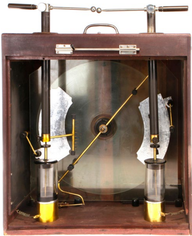
8500 Influenzmaschine „Dodd & Struthers“, Des Moines, Iowa/USA, um 1900, früher mehrfach patentierter amerikanischer elektrostatischer Induktionsapparat nach Wimshurst-Prinzip, im Mahagoni-Glas-kasten mit rückseitigem Kurbelantrieb, mit Rotor-Glasscheibe und Leydel'schen Flaschen, Größe: 52 x 63 x 27 950,- €
